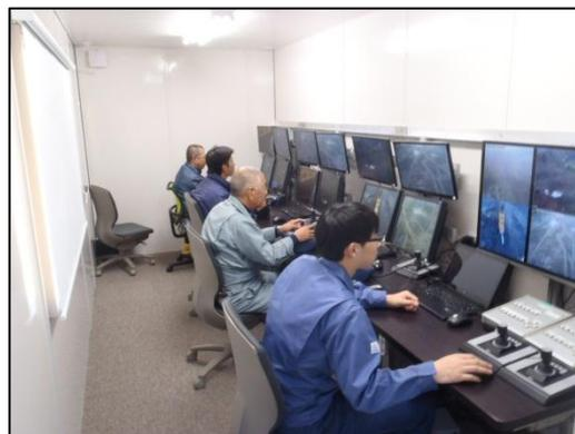
図-1 長距離無人化施工状況
