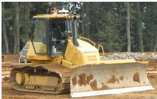
写真-1 19t ブルドーザ (コマツ D61-PXi)
