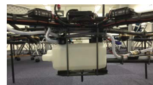
写真2. タンク部外観
