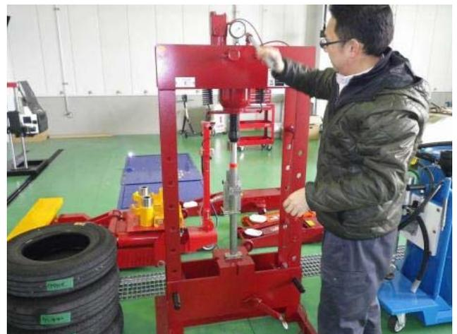
図-6 下段ストッパーの載荷試験状況
