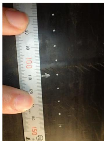
図-3 内部のひずみ量測定時のマーキング
