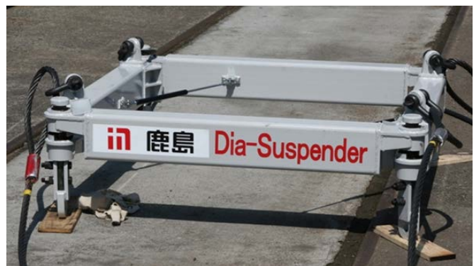
写真-2 可変吊環(4点吊用)
