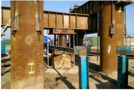
写真-3 反力杭を用いた静的載荷試験 (P87) から2D(Dは鋼管径)以上を確保した。WJの活用により杭の貫入性が向上し、仕様書に規定する鉛直精度(杭芯ずれ100mm
