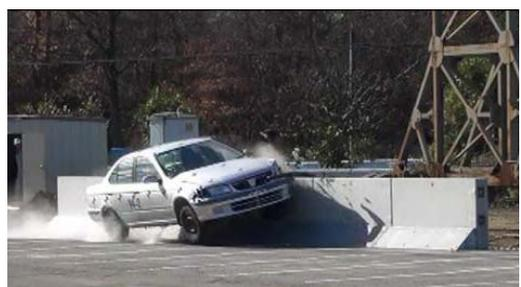
写真 3 車両衝突試験状況 (条件 B)
