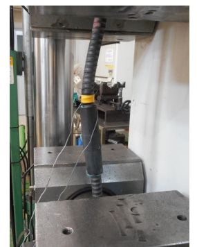
写真-2 座屈状況
