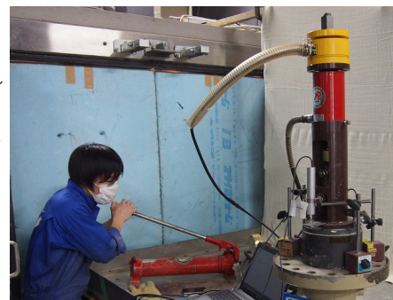
図-3 引張試験状況
