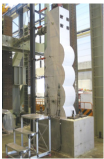
写真-1 曲げ試験状況
