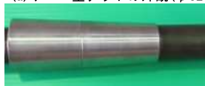
(b) PC 鋼棒にテーパナットをセットした状況 写真-1 PC 鋼棒を用いたアンカー筋の外観
