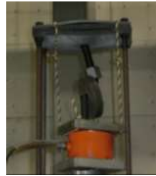
写真-2 破壊状況(PC 鋼棒 φ32 の場合)
