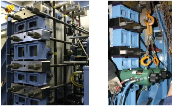
(a)加圧装置外観 (b)油圧ジャッキによる拘束圧 写真-1 加圧装置と拘束圧導入の様子
