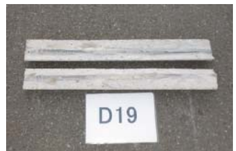
写真-6 モルタルの充てん状況
