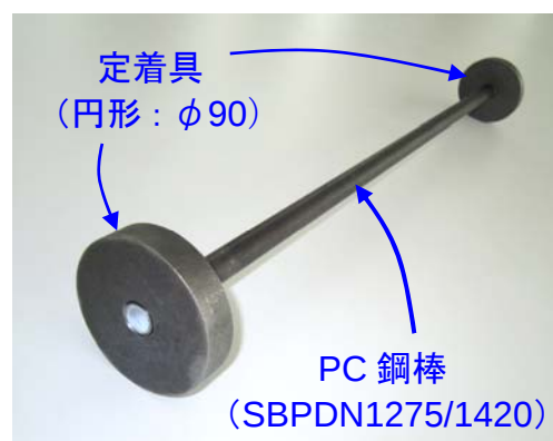
写真-1 両端に定着具を有する PC 鋼棒
