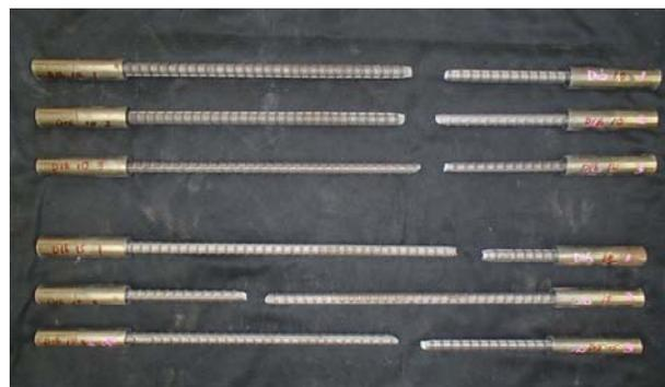
写真-1 引張試験における破断位置 (D16, 上3本10°, 下3本15°)
