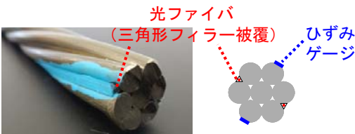
図-1 光ファイバ組込み PC 鋼材
