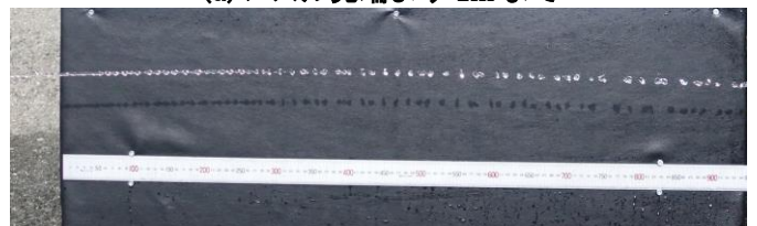
(b) ノズル先端より 1m から 2m まで 図5 層流ノズルのウォータジェット
