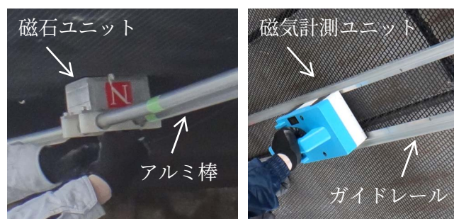
(1)磁石ユニットによる着磁
