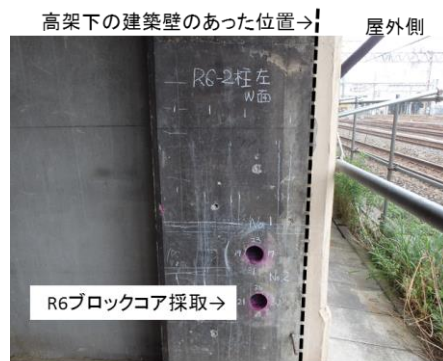
図-2 R6 柱コア採取状況
