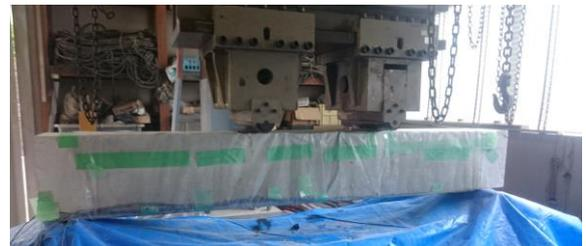
写真-1 繰返し載荷実験状況
