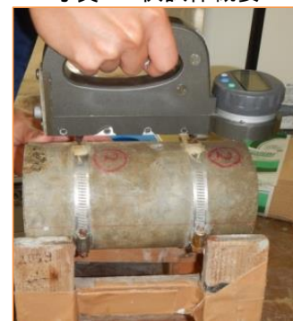
写真-2 コンタクトゲージ法
