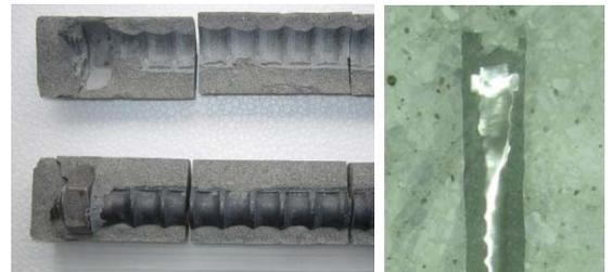
写真-3 モルタルの充填性確認
