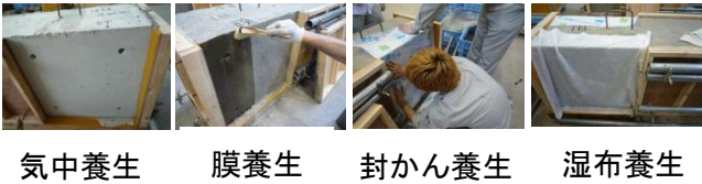
図-1 壁試験体の養生方法
