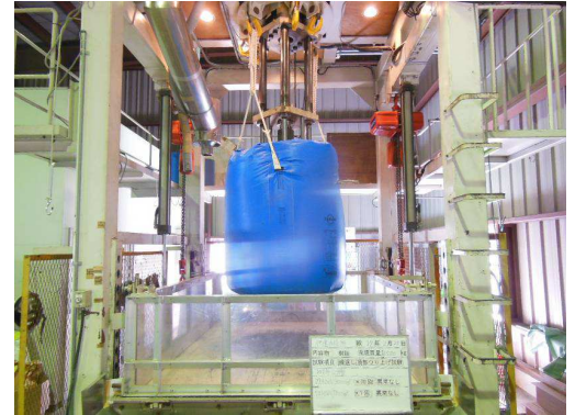
写真-2 繰返し頂部つり上げ試験状況
