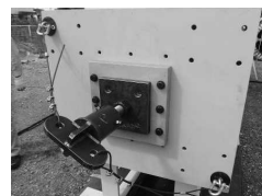
写真-3 飛出し防止装置
