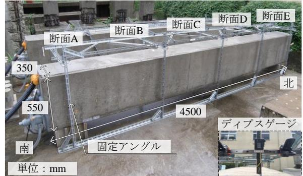
図-1 暴露状況および計測面の位置
