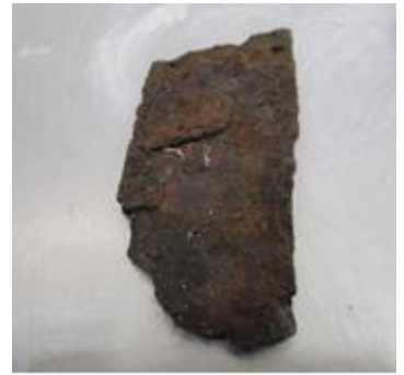
写真-2 腐食供試体の外観
