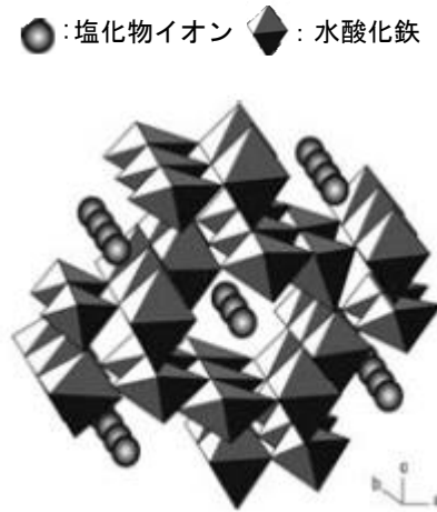
図-1 \beta -FeOOHの結晶構造モデル 2)
