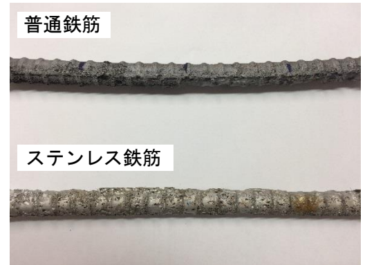
図2 主鉄筋腐食性状
