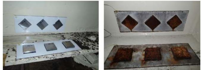
写真-1 試験片の設置状況 (左:設置直後, 1年後)
