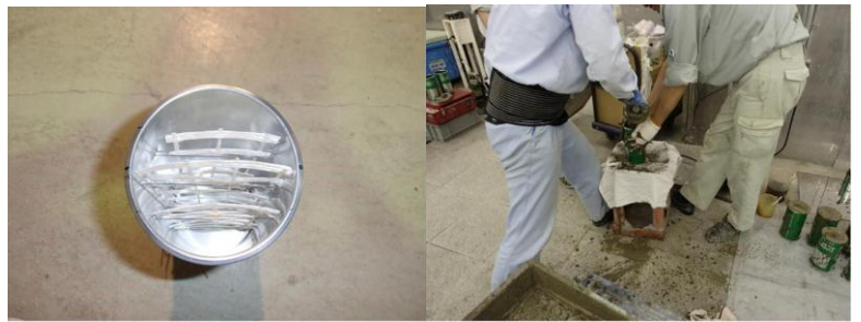
写真－2 HN の設置 (3 段) と試験体作製状況
