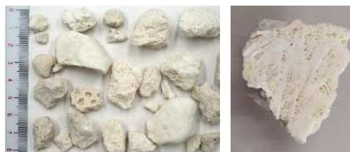
写真-1 粗骨材の外観
