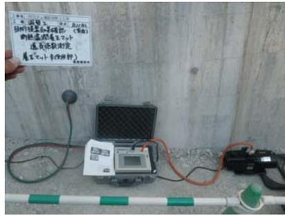
写真-2 透気係数計測状況
