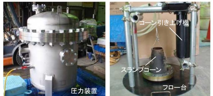
写真-1 圧力装置とフロー試験装置
