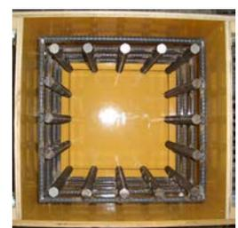
図-2 型枠と格子状鉄筋 (あき 55 mmの例)
