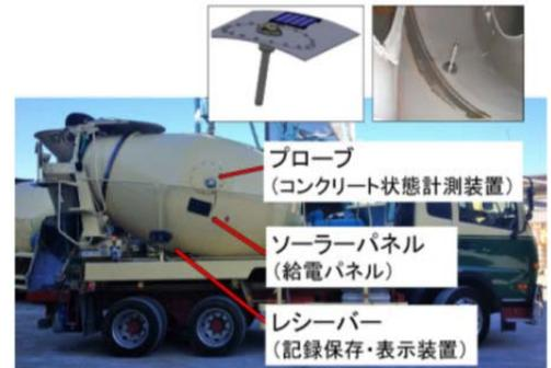
図1 コンクリート品質の連続管理装置<sup>1)</sup>
