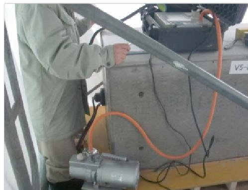
写真-2 表層透気試験の実施状況
