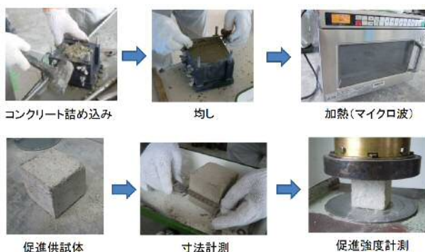
写真-1 促進強度測定までの手順
