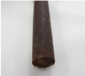
写真-1 使用した腐食鉄筋
