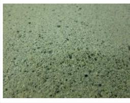
表面がザラザラしており、細骨材だけでなく一部に粗骨材も露出している。 |
