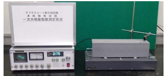
写真-2 凍結融解試験相対動弾性係数計測状況
