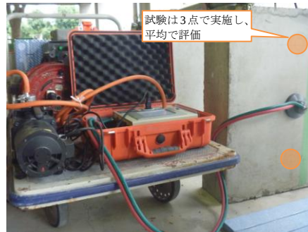
写真-2 トレント法実施状況
