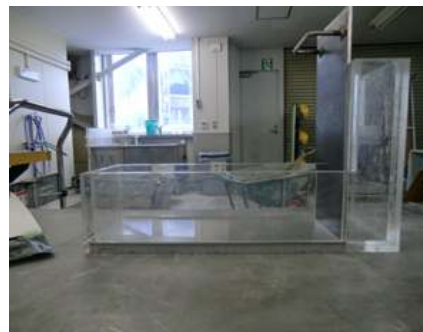
写真1 試作した小型 L 型フロー試験器
