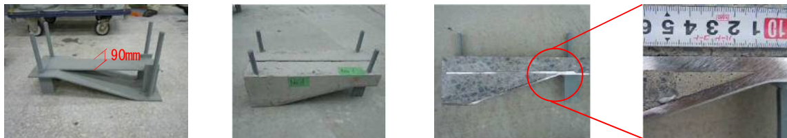
図-3 試験体の切断確認状況
