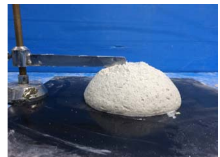
写真-4 ミニスランブ試験状況 (100mm 程度)
