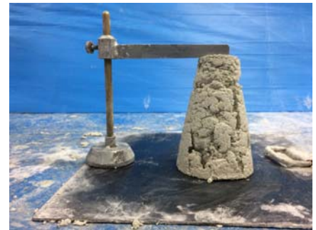
写真-3 ミニスランブ試験状況 (30mm 程度)
