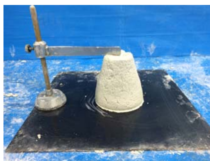
写真-2 ミニスランプ試験状況 (50mm 程度)
