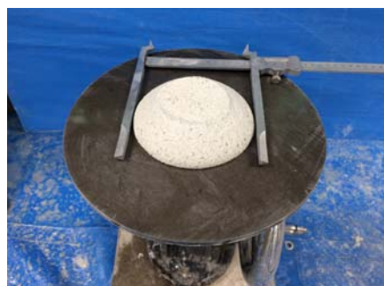
写真-1 フロー試験状況 (150mm 程度)
