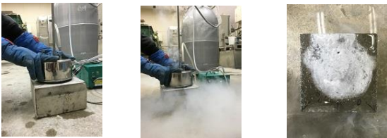
写真-2 平板供試体を用いた簡易試験の実施状況
