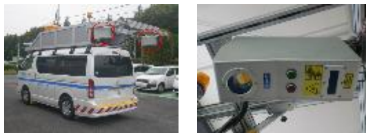
図-1 路面性状測定車と LSC
