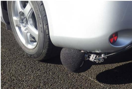
に示す左後輪後方の位置にウインドスクリーンを取り付けた普通騒音計で測定した。使用したタイヤは測定用タイヤの規格である195/65R15 91Sを使用し、空気圧は220kPaとした。
