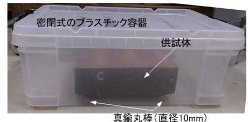
写真-1 保水性試験 (密閉容器内における水切り)
