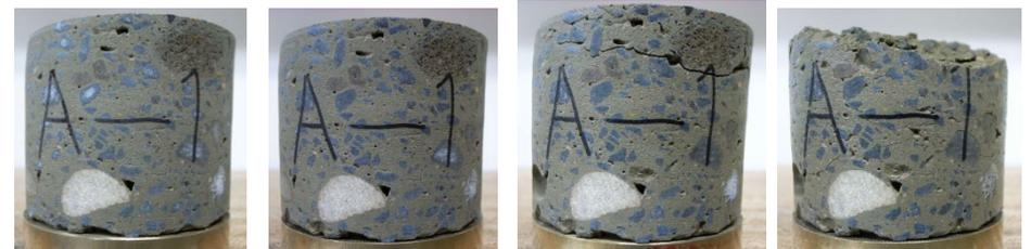
(c)混合発生土 (破壊時のサイクル $n_f=3, 6, 8$ )
